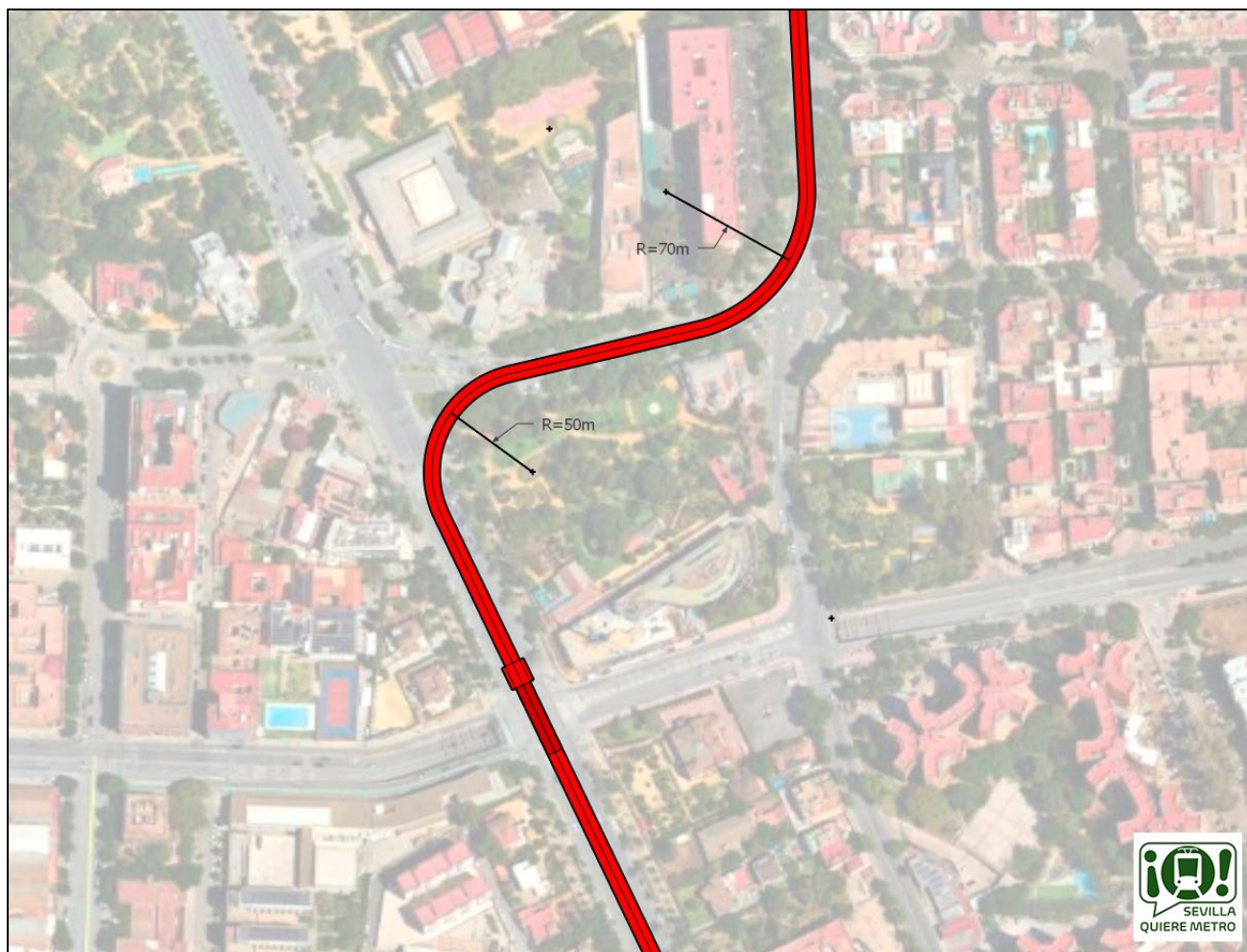
Ilustración 37. Trazado propuesto por el estudio informativo, para el cruce entre Borbolla, Eritaña y Palmera. Presenta dos curvas muy cerradas, de radio muy limitado, que generaría problemas en la explotación. Es especialmente preocupante la curva de radio de 50 m, por este punto por donde pasará la inmensa mayoría del tramo sur de la línea 3.
