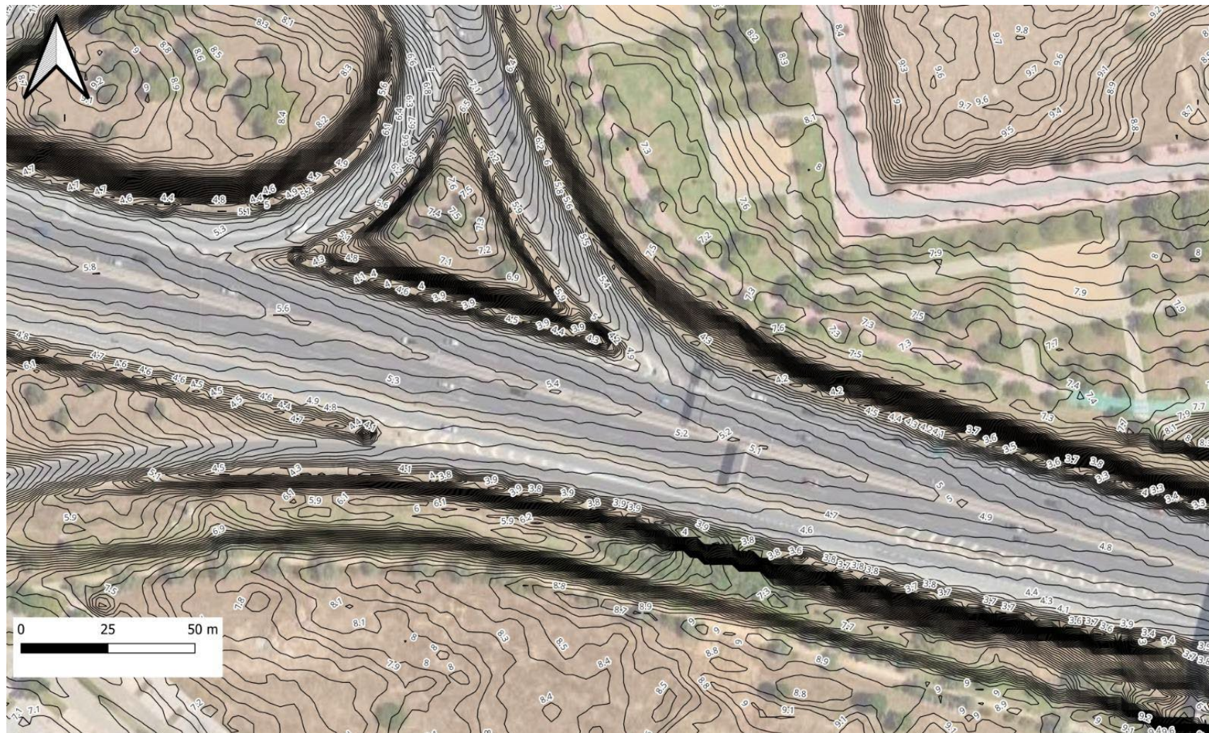
Ilustración 60. Cotas de nivel de la zona, generadas a partir del Modelo Digital de Terreno del Instituto Geográfico Nacional. Se aprecia que la SE-30 está a una cota ligeramente inferior a la del terreno que la rodea. Esto le permite salvar la ronda de circunvalación (y sus accesos), teniendo que subir menos, y por tanto, evitando el tramo en superficie por la avenida de Finlandia.
