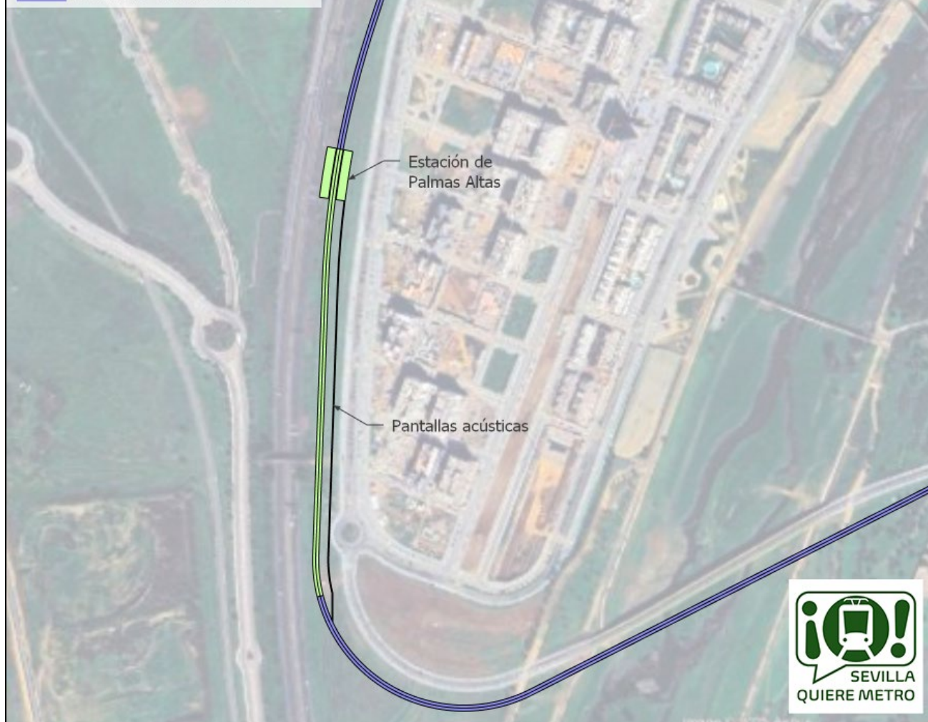
Ilustración 68. Trazado a lo largo del barrio de Palmas Altas. Destáquese que la parte inferior, la que está más al sur, se propone en viaducto, en lugar de superficie, como está planificado.
