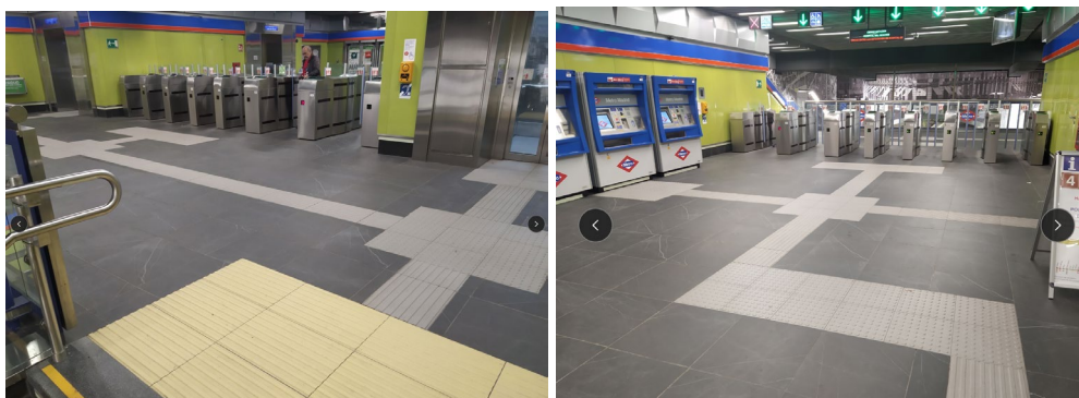
Ilustración 90. Señalización con contraste cromático y podotáctil de recorridos y elementos en las estaciones de Metro de Madrid. Fuente: Asociación Eliminando Barreras.
