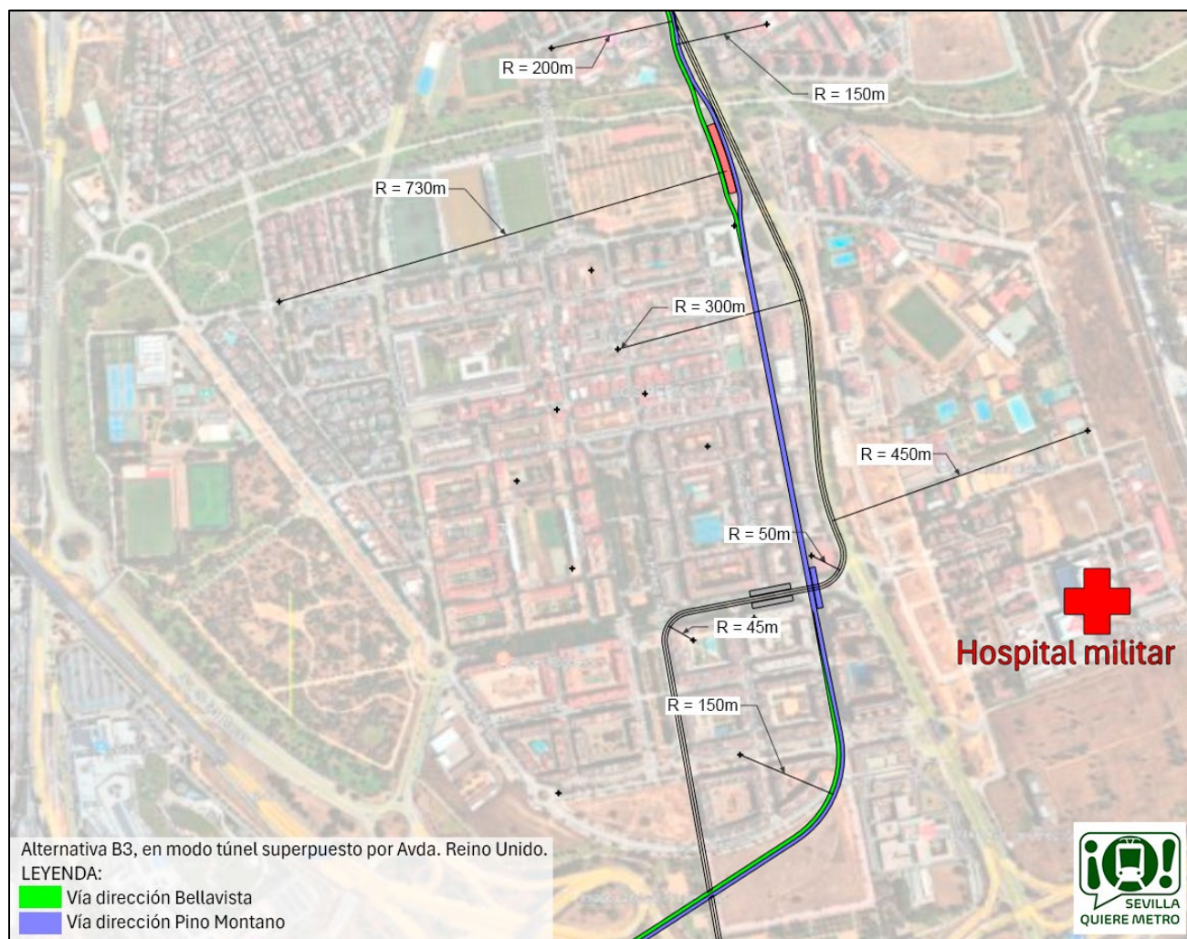
Ilustración 54. Detalle de la alternativa B3. Destáquese que en la avenida de Reino Unido hay una superposición de un túnel sobre otro.
