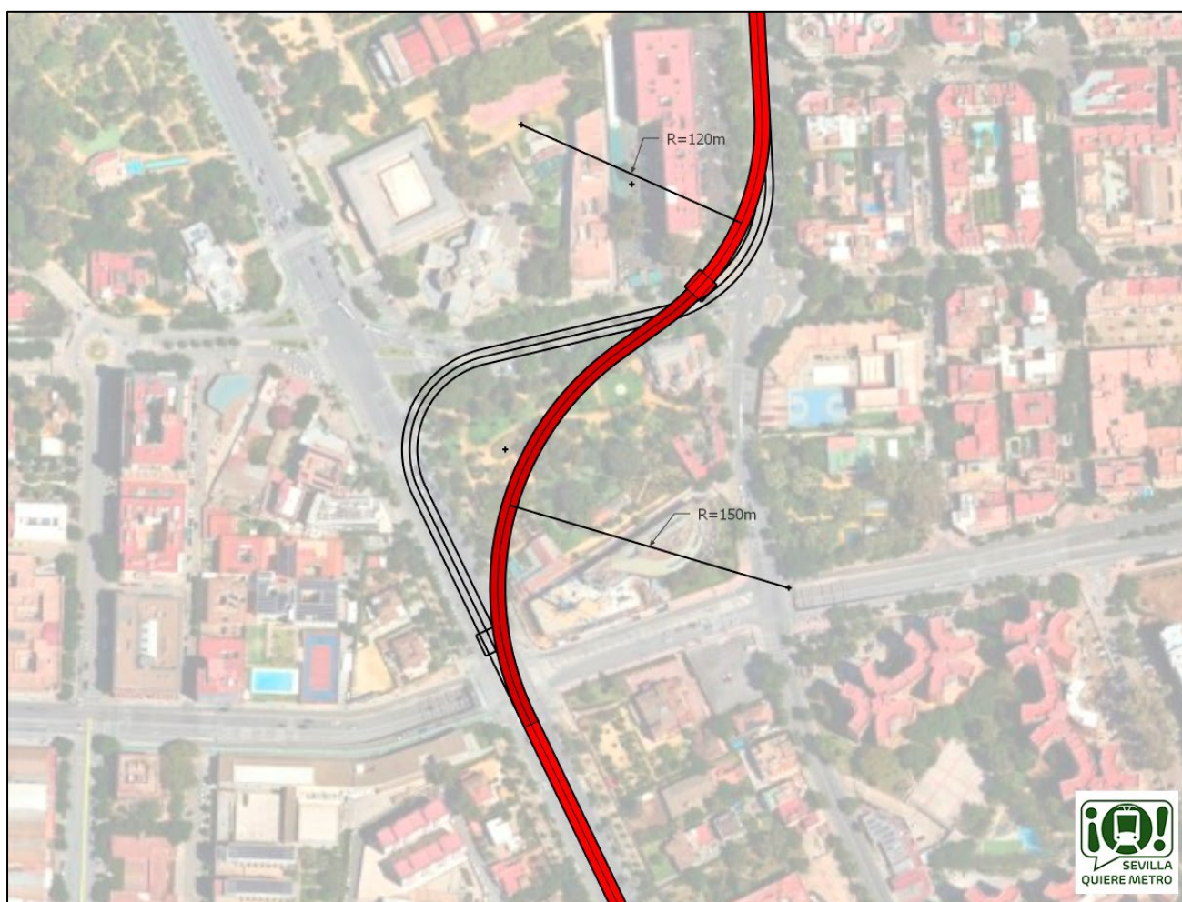
Ilustración 39. Trazado alternativo A1 propuesto para el entorno de La Palmera-Bueno Monreal, con mejora en las curvas de radio de giro. Túnel en mina propuesto para evitar las curvas de 50 y 70 metros. En su lugar, se obtiene un túnel en mina de aproximadamente 290 m de longitud, con curvas de radio de giro entre 120 y 150 m.
