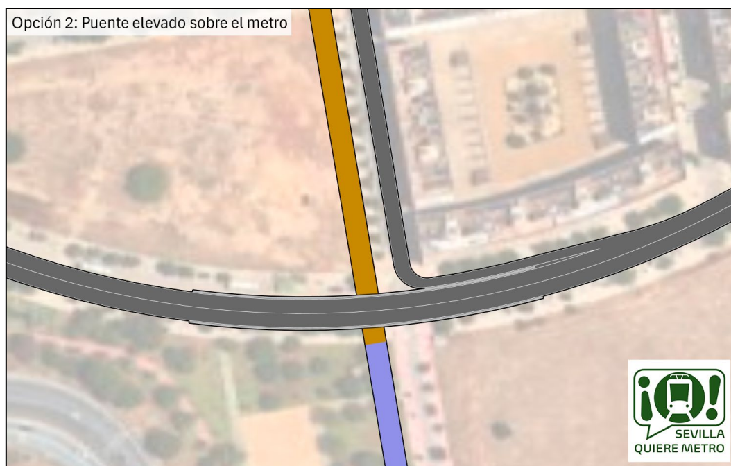
Ilustración 64. Propuesta de puente elevado en la avenida de Irlanda para superar la barrera que provocaría la rampa de subida del túnel.
