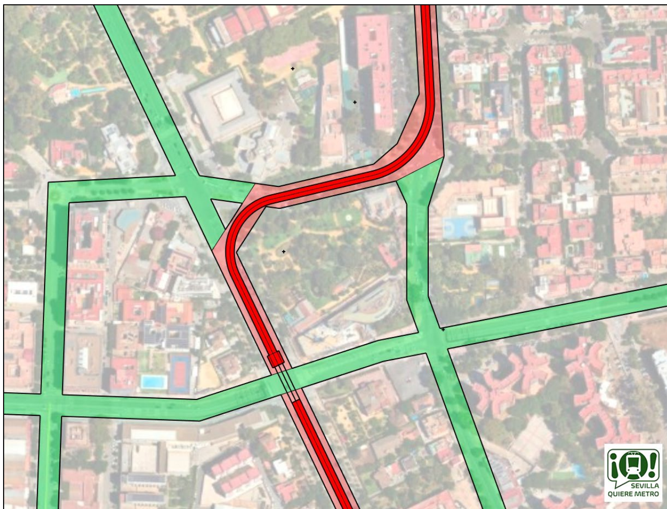
Ilustración 40. Propuesta del estudio informativo: ejecutar con muros-pantalla los túneles de la avenida de la Guardia Civil (en color rojo) y la parte de la Palmera entre la avenida de la Guardia Civil y Bueno Monreal (en color rojo).
