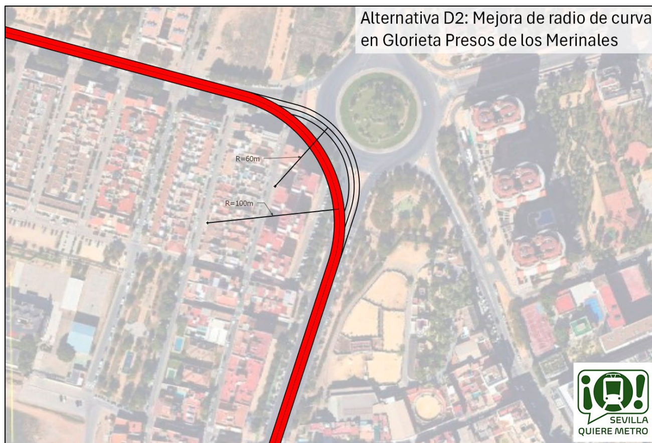
Ilustración 72. Trazado alternativo D1 propuesto para el entorno de la glorieta de los Presos de los Merinales, con mejora en las curvas de radio de giro de 60 a 100 metros.
