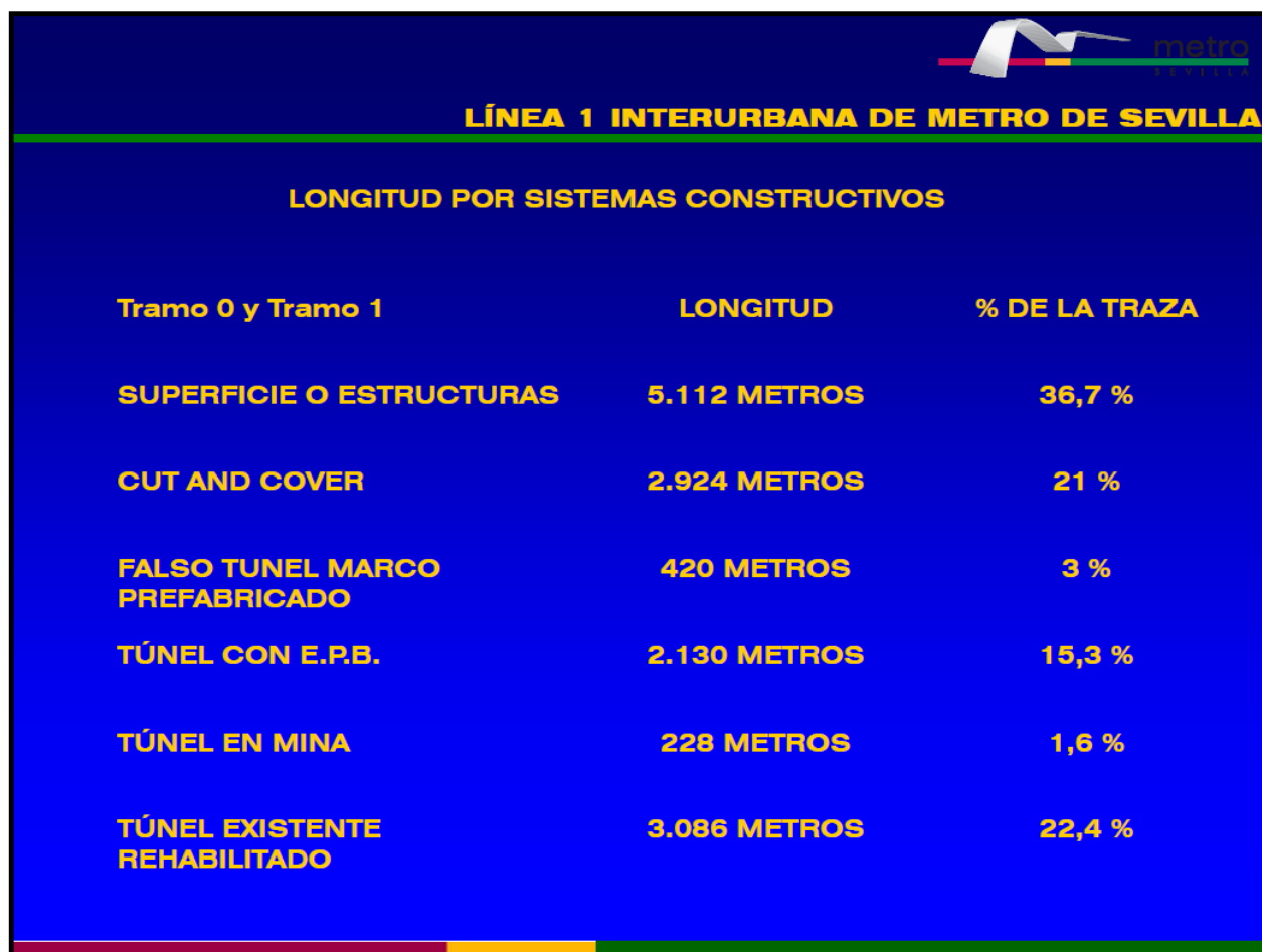
Ilustración 43. Longitud de los tramos contruidos con los diferentes sistemas constructivos para la línea 1 de metro de Sevilla. Se destaca que el túnel en mina se utilizó para 228 metros (1,6 %), y, por tanto, se tiene experiencia en ello, no siendo una innovación en la ciudad.
