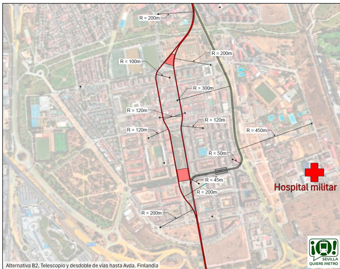
Ilustración 49. En rojo, la alternativa B2 propuesta por Sevilla Quiere Metro. En gris, la alternativa 2B propuesta por la consejería de Fomento. Destacar la mejora en los radios de curvatura.
