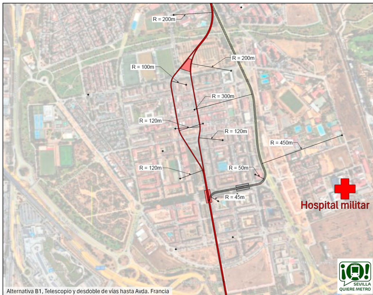
Ilustración 47. En rojo, la alternativa B1 propuesta por Sevilla Quiere Metro. En gris, la alternativa 2B propuesta por la consejería de Fomento. Se desea destacar la mejora en los radios de curvatura.
