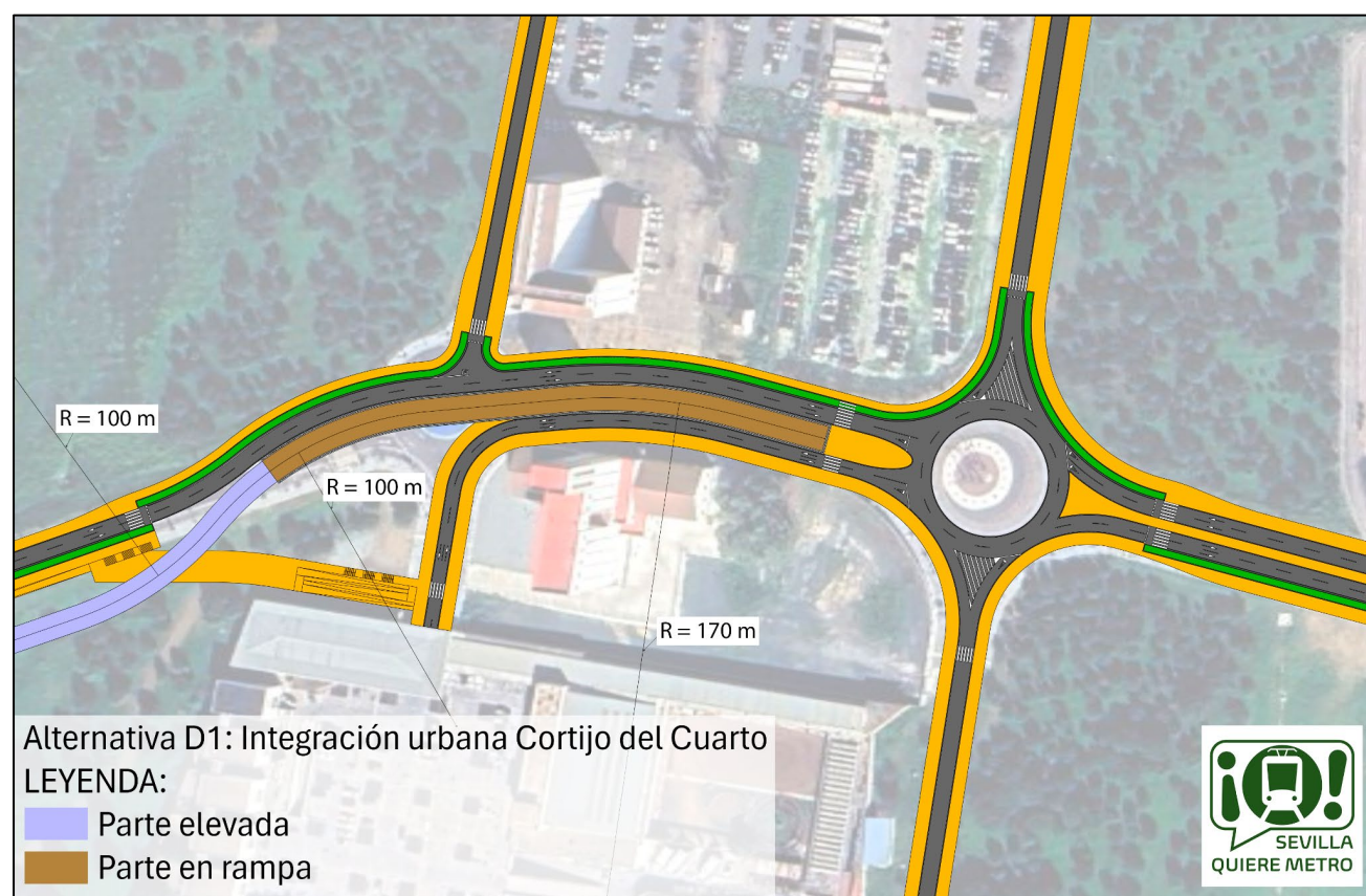
Ilustración 71. Propuesta de mejora en la entrada a Bellavista, para evitar radios de curva de 50 m. Se propone reorganizar los viales. Se desea destacar el aumento de los radios de curva, hasta el valor de 100 m.
