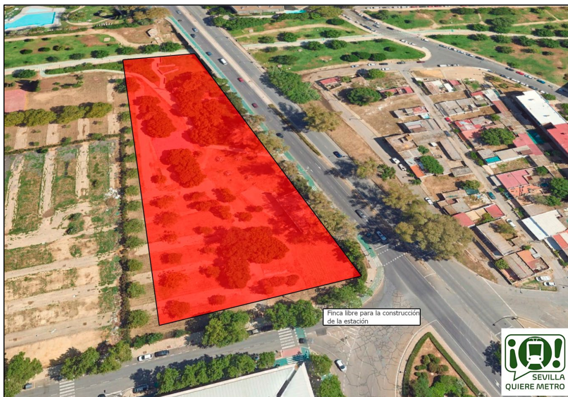
Ilustración 23. Superficie disponible para la construcción de la estación de Pineda. Esto permite construir a un solo nivel, en lugar de a dos niveles. Esta adaptación permite ahorrar costes al ajustar la estación a la demanda moderada prevista, sin comprometer el servicio a los usuarios.
